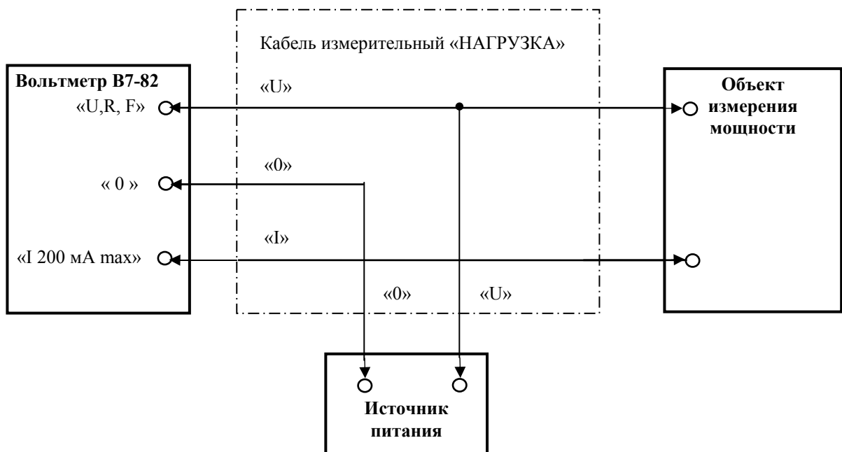
Рисунок 8 - Схема подключения объекта измерения к вольтметру при измерении мощности.
